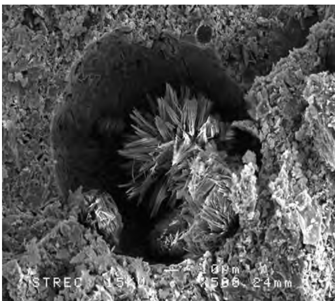
Fig. 2 : développement d'une structure cristalline au sein de pores dans la matrice de béton.
